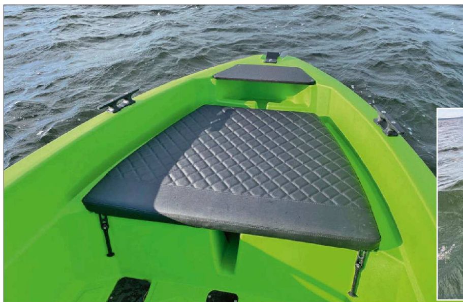
Le coussin de la banquette avant est intégré au capot et se soulève pour accéder à un coffre.
